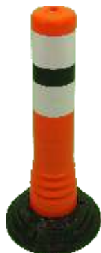
12236-K0 Flexipfosten® Farbe: Orange, TPU/ABS H:450 mm, Ø200/80 mm, 1.1 kg 2 x Reflexstreifen RA1- weiß ohne Kleber
