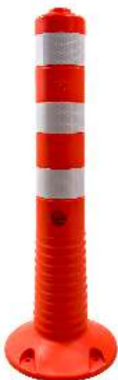
14237-FP Ping Pong Farbe: Orange, TPU H:750 mm, Ø260/110 mm, 2.1 kg 3 x Reflexstreifen RA2- weiß Befestigungsset erforderlich: 1 x (13459-S4)
