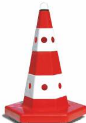
12301-RW Sechseckkegel Farbe: Rot, PPC (340x390) x 525 mm, 4.1 kg 2 x Signalstreifen mit integrierten roten Reflexlinsen, M36 Gewinde rutschhemmender Zusatzring Farbe: Schwarz, PVC
